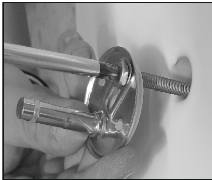
03 Avvitare il fissaggio ma non bloccare. Tighten the fixing screw do not block it.
